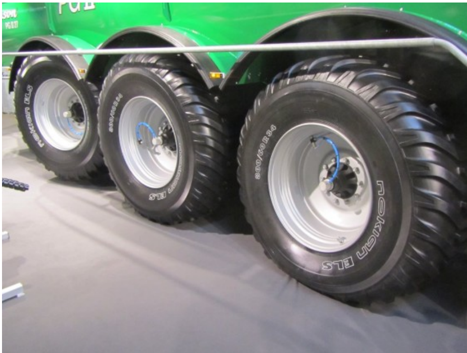
Billede 3. Montage af et system til dæktryksregulering sænker brændstofforbruget og minimerer strukturskader. Foto: Henning Sjørslev Lyngvig, VFL.
